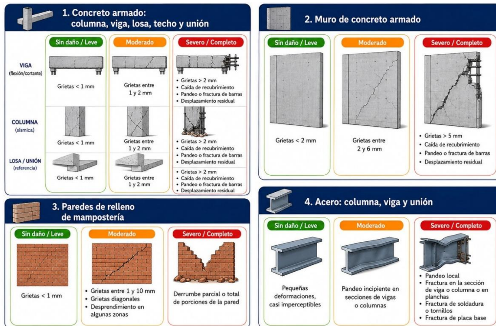
Figura 1. Clasificación de daño por tipo de elemento. Adaptada del Boletín 61 ANIH (2023).
