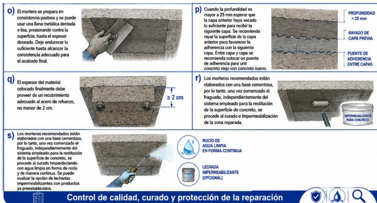
Figura 9. Reparación de nervios en losas nervadas (continuación). Elaboración propia.
