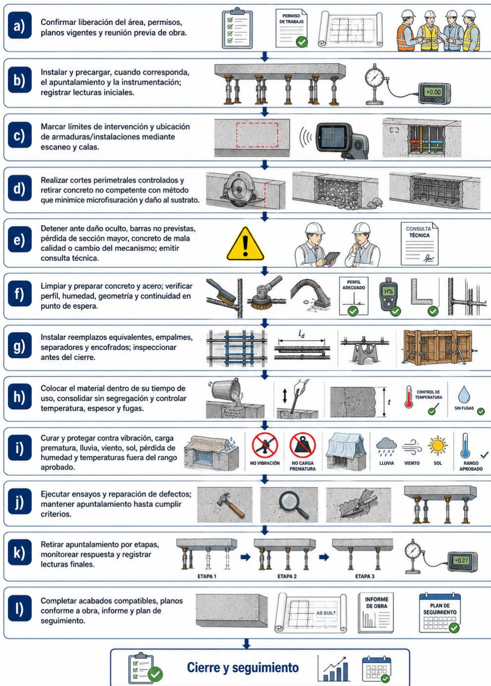
Figura 3. Secuencia general para reparación. Elaboración propia.
