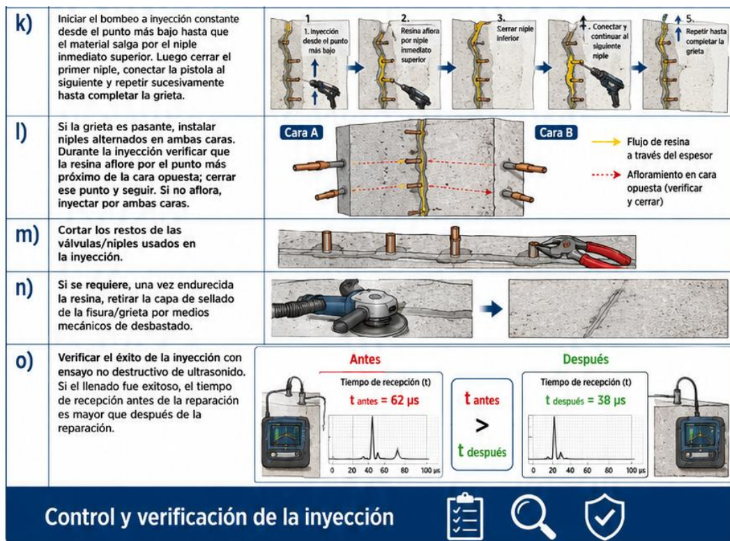
Figura 10. Proceso de inyección en grietas y/o fisuras ( continuación ). Elaboración propia.
