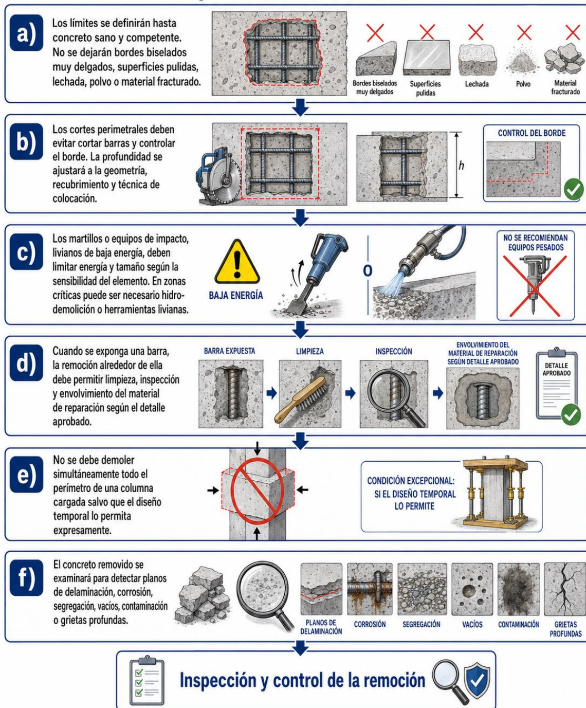
Figura 4. Secuencia general para remoción del concreto. Elaboración propia.
