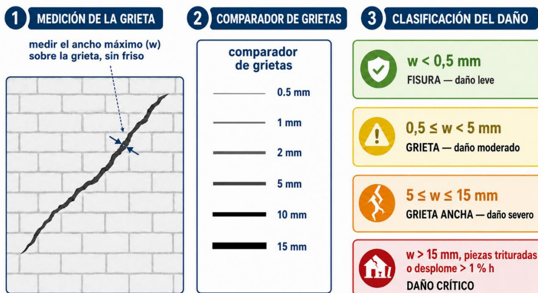
Figura 1. Medición y clasificación del daño según el ancho de grieta. Fuente: elaboración propia, según lo establecido en ICH (1985), AIS (2001), INIFED (2021) y Ramírez (2022).
