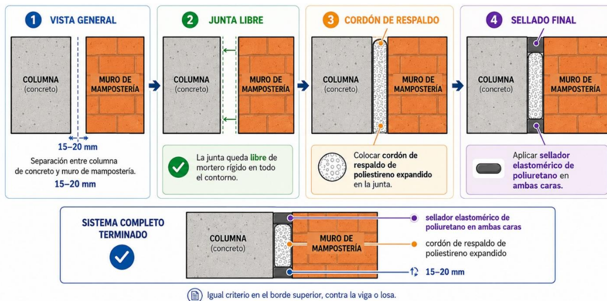
Figura 12. Reparación de junta en mampostería separada. Fuente: elaboración propia.
